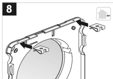
Im nächsten Schritt setzen Sie bitte die Außenblende [7] mit der geschlossenen Kante nach oben auf den Wandanschluss – achten Sie dabei darauf, dass die Schnappverbindungen einrasten.
