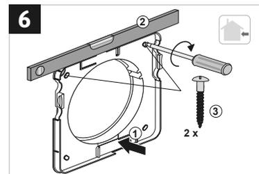
Anschließend schieben Sie die Tropfkante von unten unter den Wandanschluss und montieren die zwei unteren Schrauben und ziehen dann alle vier Schrauben fest.
