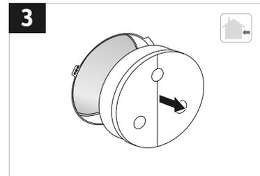
Nutzen Sie den Wandanschluss als Schablone und zeichnen Sie die Bohrlöcher zur Befestigung an. Achten Sie hierbei auf den richtigen Sitz des Wandanschlusses und kontrollieren Sie diesen mit einer Wasserwaage.
